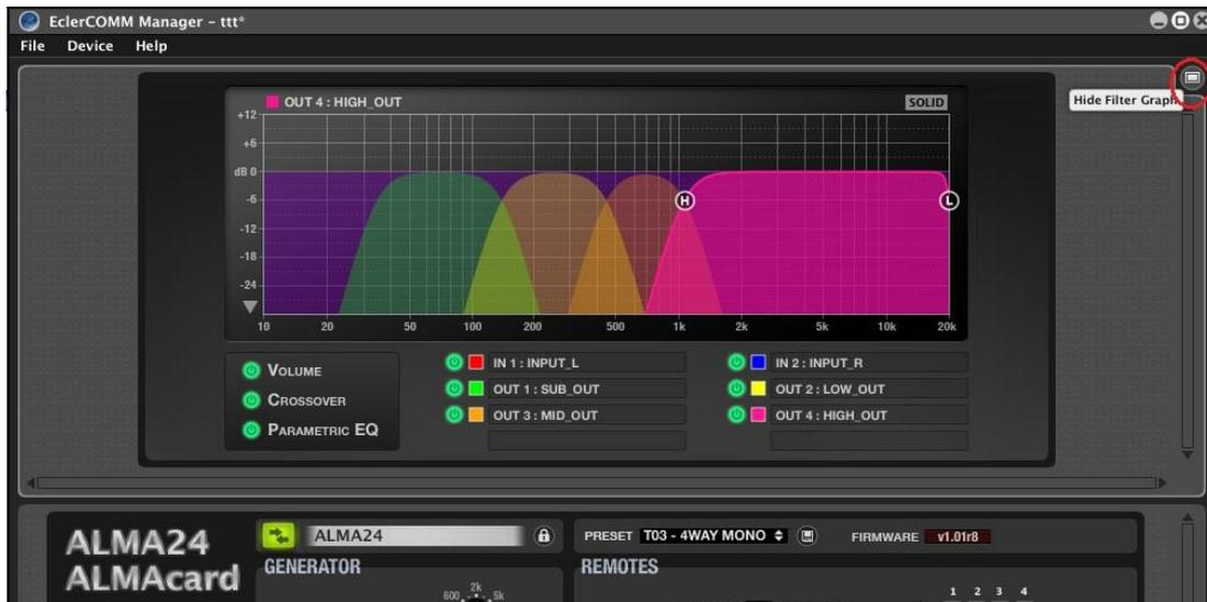
Dans cette fenêtre, vous pouvez visualiser une représentation graphique du volume, du traitement des filtres répartiteurs (crossovers) et correcteurs paramétriques de chacune des entrées et sorties, il est même possible de régler les paramètres de filtrage en temps réel à l'écran, en cliquant sur les icônes circulaires disponibles pour chaque filtre et en les tirant dans la représentation graphique.
