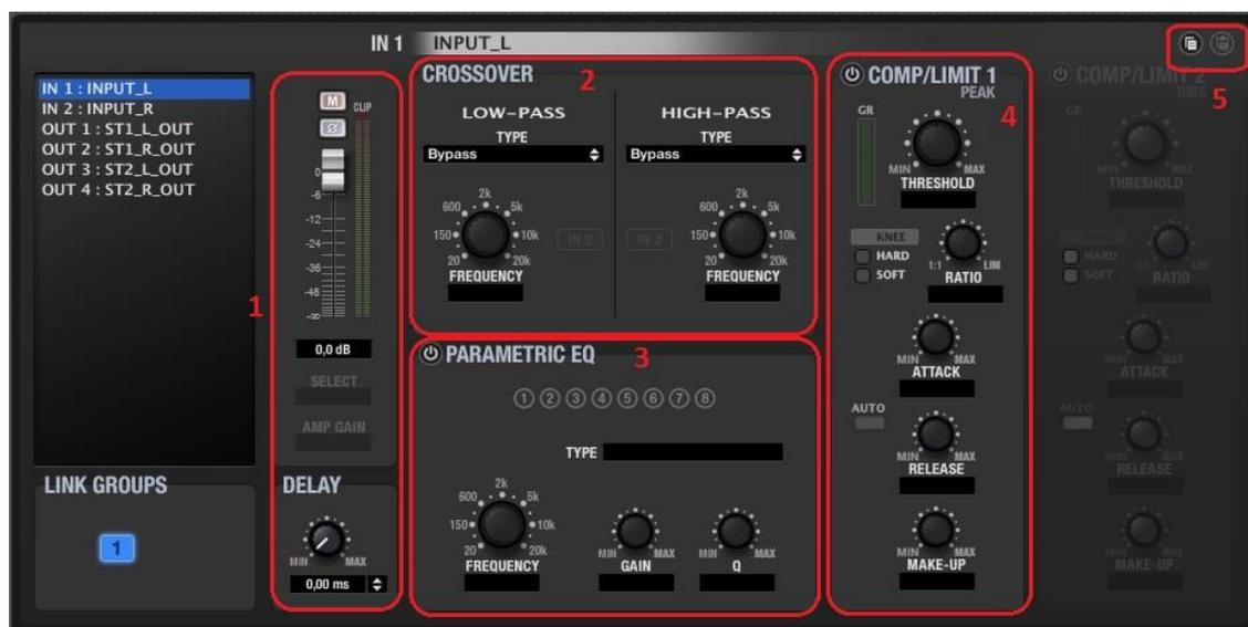
1. Commandes de **volume**, de **coupure du son (MUTE)**, d'**inversion de polarité** et de **retard** (jusqu'à 1 seconde, affiché en unités de temps ou de distance). Cela comprend également deux VU-mètres, un « pré-traitement » et l'autre « post-traitement » du canal d'entrée.
