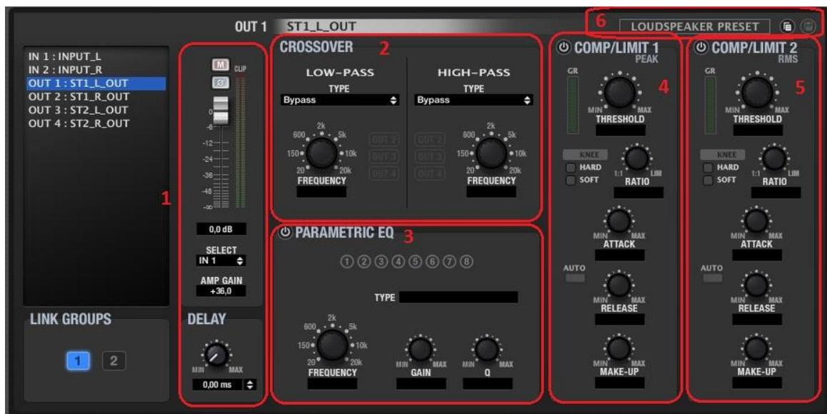
1. Commandes de **volume**, de **coupure du son (MUTE)**, d'**inversion de polarité** et de **retard** (jusqu'à 1 seconde, affiché en unités de temps ou de distance). Cela comprend également deux VU-mètres, un « pré-traitement » et l'autre « post-traitement » du canal de sortie.
