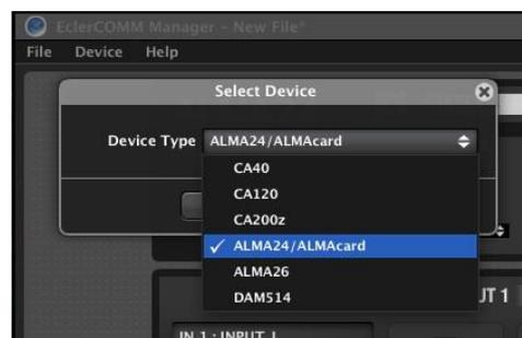
Puis en cliquant sur le bouton **Connect with Device**, il est possible d'établir la communication avec l'appareil, après avoir choisi l'option de synchronisation (**SEND** pour envoyer la configuration actuelle à l'appareil ou **GET** pour recevoir dans l'application la configuration actuelle de l'appareil) :
