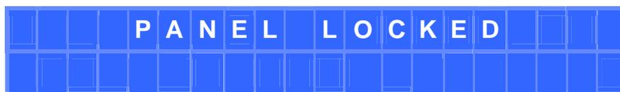
Pour réactiver les commandes de la face avant, il est nécessaire de saisir le mot de passe mémorisé. Pour cela, affichez le menu de verrouillage (touches MENU gauche et droite simultanément, pendant 2 secondes). L'écran suivant s'affiche :
