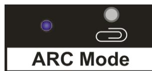
Appuyez sur le bouton avec un trombone ou un autre outil pointu pour activer le mode ARC : la LED de gauche s'allume en bleu. Appuyez à nouveau sur ce bouton pour quitter le mode ARC et éteindre la LED.
