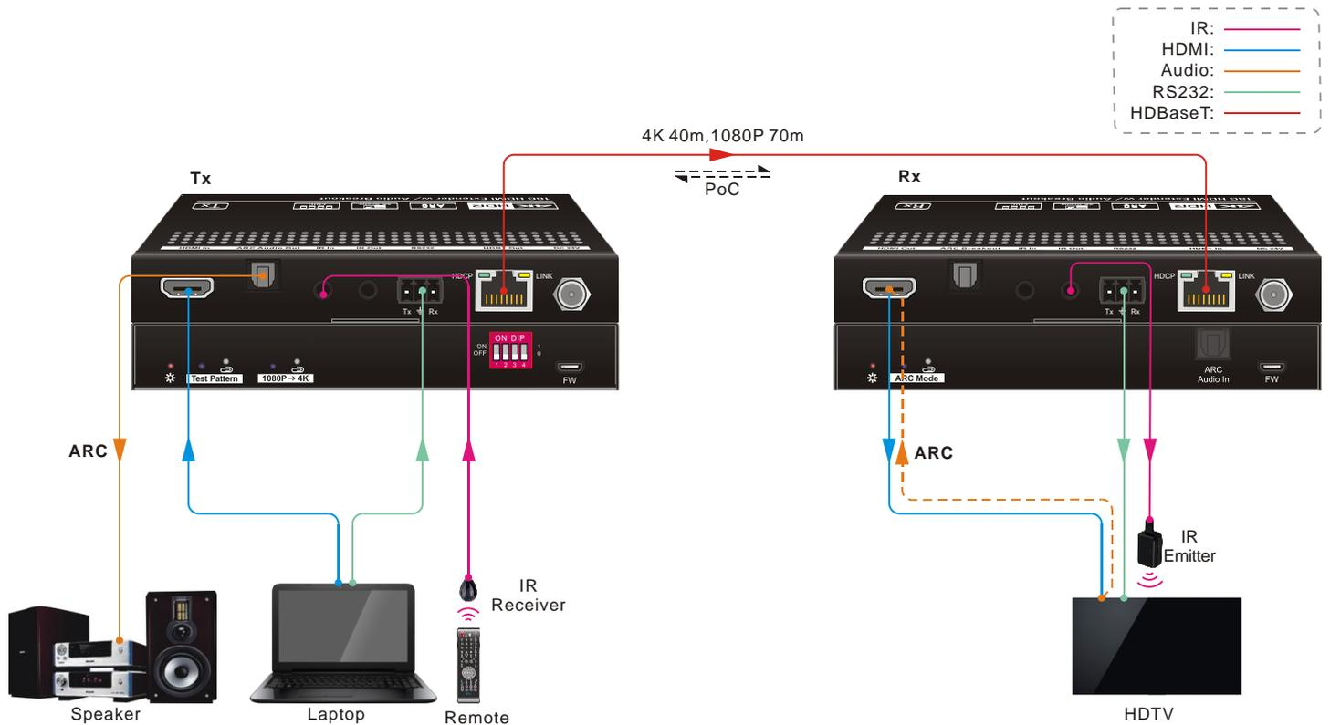
**Note :** un câble STP est recommandé pour des performances optimales de l'appareil en mode ARC.
