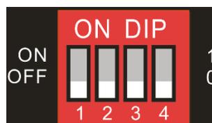
Les commutateurs **1~3** servent au réglage de l'EDID. Les réglages correspondant à la position du mini-commutateur DIP sont indiqués à l'arrière du produit.
