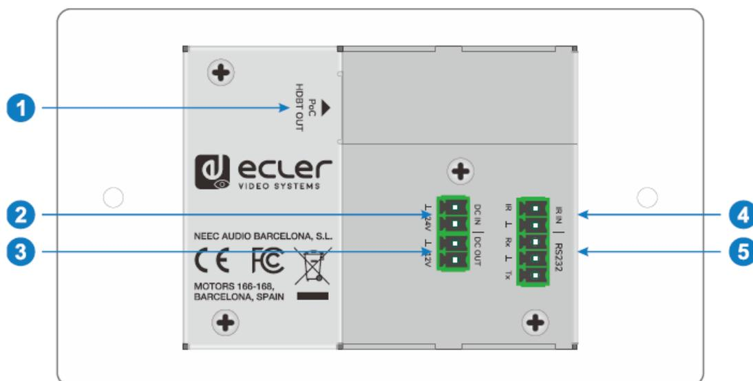
1. **HDBT OUT (POC) :** port RJ45 de sortie HDBaseT à raccorder au port d'entrée HDBT IN du récepteur par câble CATx. Il prend en charge la fonction d'alimentation PoC 12 V-48 V permettant au commutateur d'être alimenté par un récepteur compatible.
