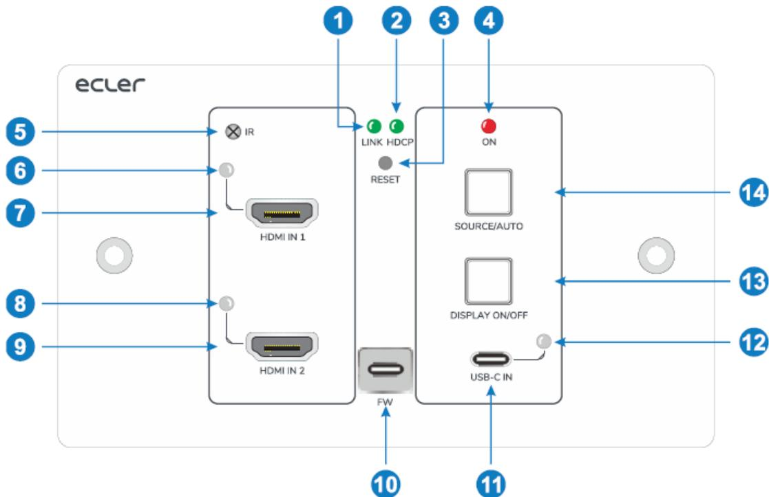
1. **LED LINK** : la LED s'allume en vert lorsque l'émetteur est bien connecté au récepteur par un câble CATx.
