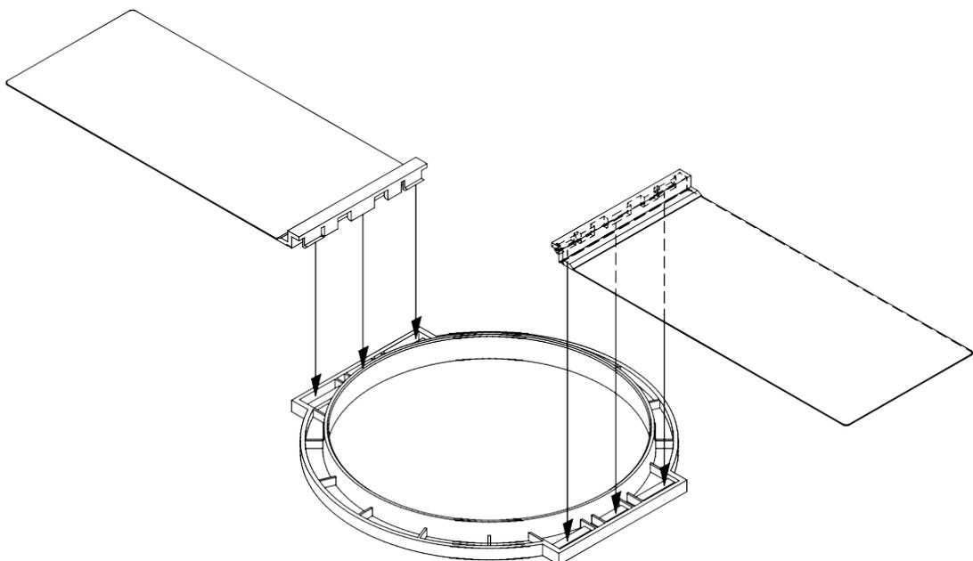
2. Insérez l'ancrage assemblé dans le faux plafond.
