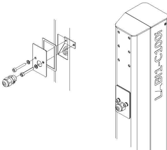
1. Connectez le câble audio à la colonne et faites-le passer au travers du cadre et du trou rond du LABI1-ODCNX.
