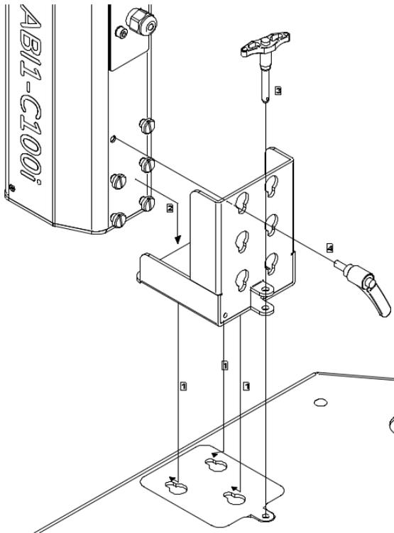
1. Fixez le LABI1-SAC aux orifices de montage du caisson de basses.
