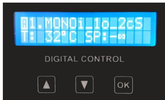
Avec les touches de flèches vers le haut et le bas, il est possible de sélectionner l'un des 18 presets. Maintenez le bouton OK enfoncé jusqu'à ce que la barre de chargement ait atteint sa fin dans l'écran LCD pour terminer la sélection et pouvoir utiliser le preset souhaité. En cas de coupure de courant, le DSP reprend son dernier preset au redémarrage.
