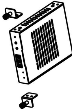
2. Insérez le produit avec ses équerres de montage dans l'accessoire de rack 3U (12 unités peuvent être installées verticalement), comme dans l'illustration ci-dessous :
