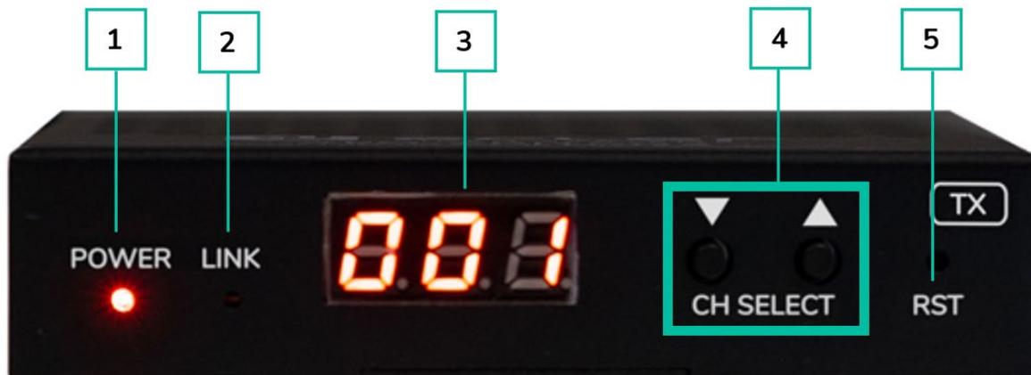
1. **LED POWER** : la LED clignote lors de la mise sous tension de l'appareil et reste fixement allumée (en rouge) une fois la phase de démarrage terminée.
