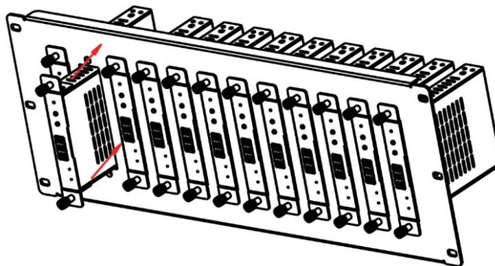
3. Utilisez des vis pour fixer les équerres de montage au rack afin d'achever le montage, comme dans l'illustration ci-dessous :
