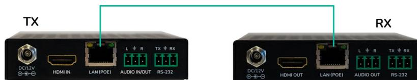
1. **Connectez l'appareil source** au port HDMI de l'émetteur VEO-XTI1CG2.
