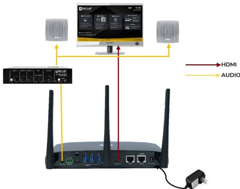
Les VEO-SWC44TH et VEO-SWC44TU peuvent transmettre un signal audio à l'unité de base VEO-SWC44 lorsque la sortie audio de l'appareil source est sélectionnée.
