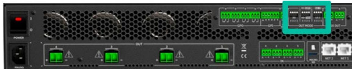
Sélectionnez le mode de fonctionnement approprié pour ne pas endommager les enceintes. **Ne connectez jamais de charges inférieures à 2 ohms lorsque vous travaillez en mode basse impédance.**
