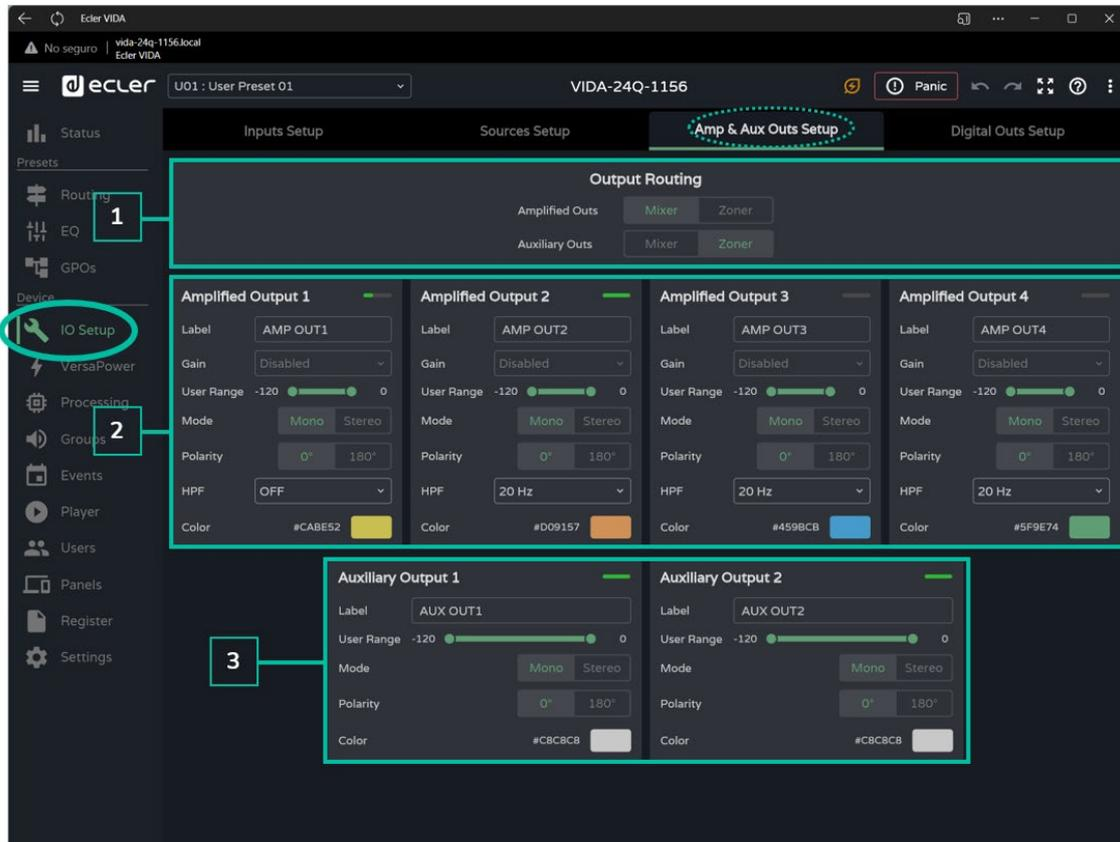
1. Output routing : sélection du mode de routage des signaux amplifiés et auxiliaires.
