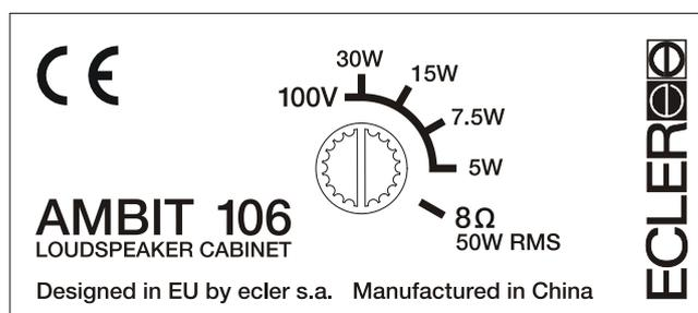
L'AMBIT106 dispose de 4 niveaux différents de puissance en ligne 100V qui permettront, suivant le secteur à sonoriser, d'atténuer plus ou moins l'enceinte. Ainsi,
